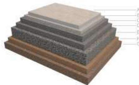
PRÍKLAD SKLADBY VRSTVIEV PRE VOZIDLÁ NAD 3,5 t
