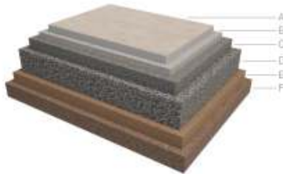
PRÍKLAD SKLADBY VRSTVIEV PRE VOZIDLÁ DO 3,5 t
