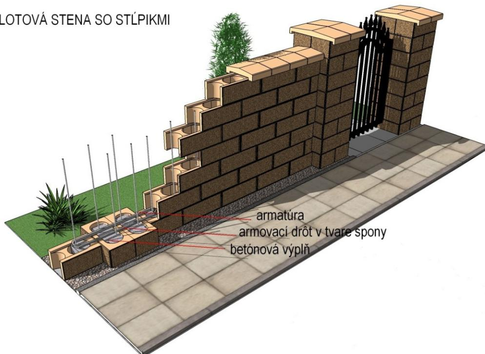
Vložený betón sa hutni, napr. oceľovou tyčou. Stĺpy sa spravidla armujú po celej výške.
